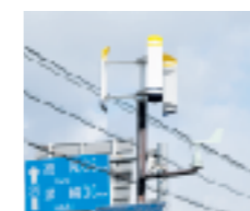
小型風力発電機/コキングトルクや鉄損が発生しない
