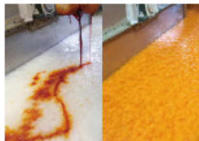
植物性繊維の染色に最適な直接染料による 原料の先染めの様子
