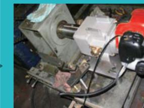
減速機は、農機具製品のウォーム減速機を改造し試作機1号を製作するも、正転逆転が不便で断念。平行軸段車式減速機で正転逆転機能が実現。
